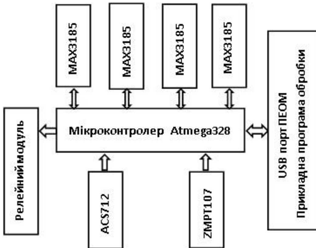
Рис.1. Структурна схема термостата
